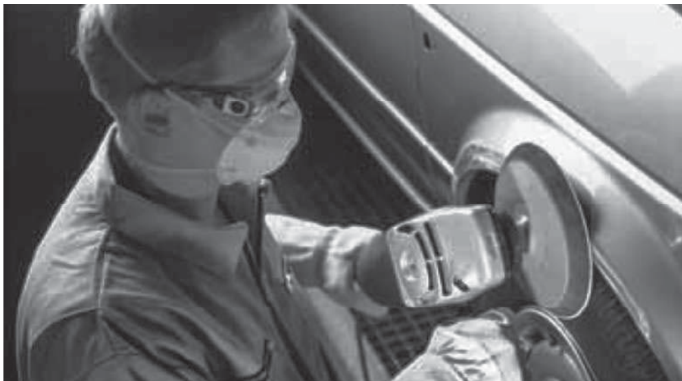
Rys. 17.7. Polerowanie powierzchni karoserii samochodowej [KLING]
